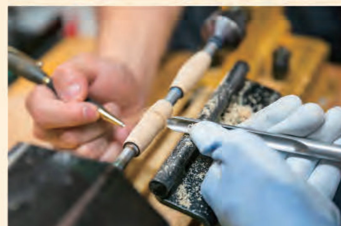
「すくい」という刃物を当て、水平に保ち左右に動かしながら削り出す。
