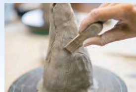
焼成後85%ほどに縮むことを想定し、大きさや形を整え、装飾を施す。
