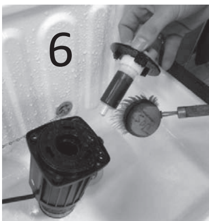
Rotor mit Wasser und Bürste reinigen
