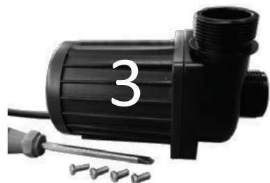
Schrauben vom Pumpengehäuse entfernen
