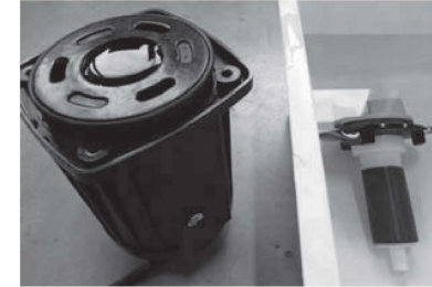
2. Pumpengehäuse 45° drehen im Gegenuhrzeigersinn (links) (nur DM30000S)
