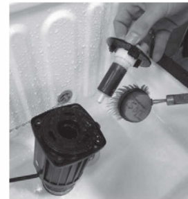
4. Laufrad vom Pumpengehäuse entfernen und mit Wasser und Bürste reinigen
