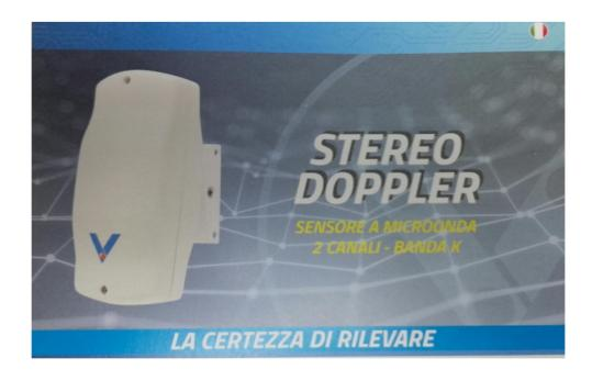
Il sensore a microonde STEREO DOPPLER è stato sviluppato secondo tecnologie avanzate, che lo pongono ai livelli più alti della sua categoria. Grazie alla tecnologia in banda K (24GHz), che ha minore penetrazione nelle pareti, riesce a proteggere unicamente l'ambiente controllato evitando di rilevare movimenti al di fuori di esso.
