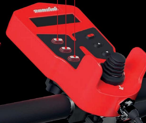
Positionierung der Raupenkettens in maximal geschlossener Stellung. Taste oben, links vom Joystick. Die Raupenkettens schließen sich vollständig und ermöglichen das Aufsetzen der Räder auf dem Boden, was das Wenden auf schmalen Treppen und Stufen von Raumpartreppen erleichtert.
