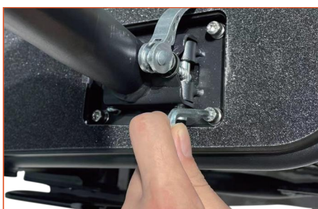
1.付属品の六角レンチで、周りのネジを取り外します。
