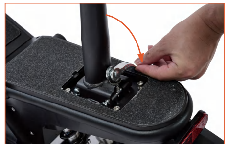
3.固定レバーを下向きに押し、サドルが揺れないければ、組み立ての完成です。
