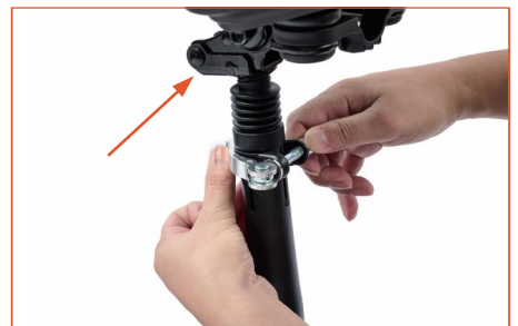
6.適切な高さに調節してから、レバーを締めます。
