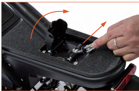
1.固定レバーを右へ抑えながら、シートピラーを立たせます。レバーを外せば、レバーの左側に有る小柱はシートピラーの穴にはめ込むようにしてください
