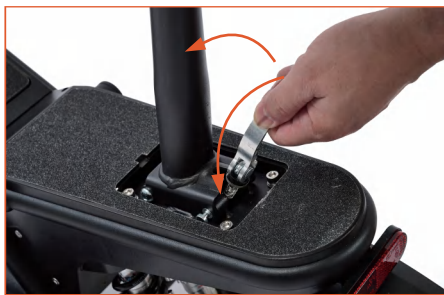
2.固定レバー起こし、角度を調節します。シートピラーを溝にしっかりはめ込んでください。
