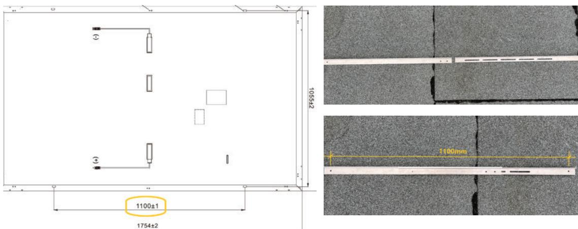
Verschraube die zweiteilige Querverstrebung mit jeweils 2x M6x20mm, 2x M6 Muttern und 4x Unterlegscheiben.
