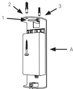
Bohren Sie die Löcher in der Decke (**Lochabstand: 48mm, Bohrerdurchmesser für mitgelieferte Dübel: Ø 5mm**). Führen Sie das Deckenkabel durch das Loch (1) der Halterung (A). Verwenden Sie geeignete Dübel und Schrauben und schrauben Sie die Halterung an den Löchern (2) + (3) an die Decke.
