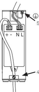
Führen Sie das Leuchtenkabel zuerst durch das Loch im Baldachingehäuse (B) und dann durch die Zugentlastung im unteren Bereich der Halterung (4). Schließen Sie anschließend das Kabel an das Netzteil (+ braun, - weiß) an und schrauben Sie die Zugentlastungsschraube fest ein. Schließen Sie dann das Netzteil an die Stromversorgung an. Achten Sie darauf, den Schutzleiter an der Buchse in der Halterung (5) anzuschließen.
