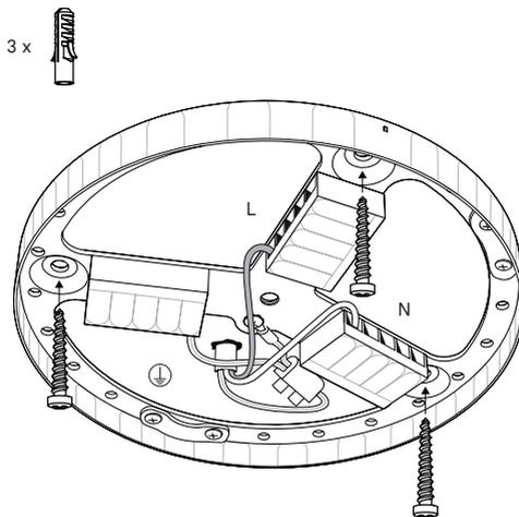
Schrauben Sie den Deckenhalterung mit den mitgelieferten Schrauben fest. Verwenden Sie die mitgelieferten Dübel oder andere zur Unterkonstruktion passende Dübel (Bohrerdurchmesser für mitgelieferte Dübel: Ø 5mm).
