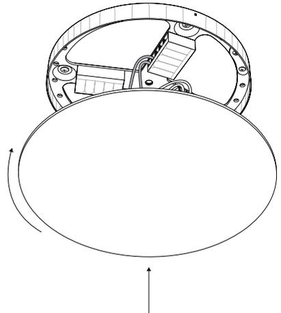
Die Kabel der Leuchten können an beliebiger Position befestigt und herausgeführt werden. Lösen Sie die Schrauben der Zugenlastungsklemmen und positionieren Sie sie an der gewünschten Stelle. Klappen Sie die Lasche der Kunststoffblende nach unten und befestigen Sie das Kabel der Leuchte mit der Zugenlastungsklemme darauf. Schließen Sie anschließend die Litzen an den entsprechenden Klemmen an.
