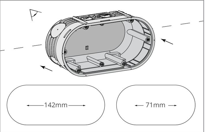
**3. Mit der Lochsäge von Corston 71-mm-Löcher bohren**
