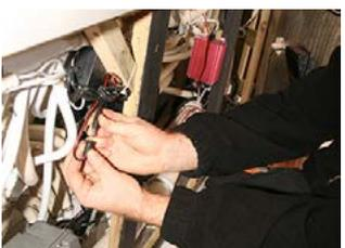
**ÉTAPE 4** - Couper l'alimentation de l'amplificateur en tirant sur les connections
