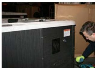
**ÉTAPE 1** - Dévissez les panneaux latéraux pour avoir accès à la pompe du côté du grillage de ventilation et le boîtier du lecteur MP3
