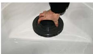
**Étape 2.** Pour soulever le panier, tourner dans le sens antihoraire jusqu'à ce que la partie plate du panier s'aligne avec la partie plate du boîtier de filtre
