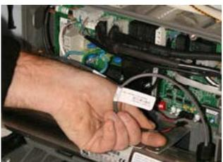
**ÉTAPE 5** - Débranchez les deux fils des capteurs sur la carte électronique, pincer les barrures vers le bas et retirer retirer la fiche de connection.
