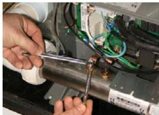
**ÉTAPE 6** - Dévissez les écrous du chauffe eau à l'aide d'une 3/8 clé Placer le parti ouvert de la clé 6 mm sous la languette de cuivre et dévisser l'écrous supérieurs à l'aide de la clé 3/8
