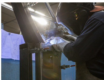
Soudure et assemblage du vélo André Martin dans les ateliers de STPL (69)
