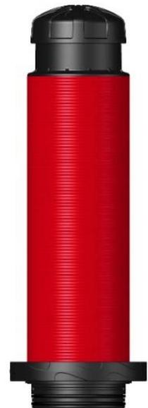
Sus aletas deflectoras consiguen un movimiento helicoidal del agua que entra en el filtro. Este movimiento provoca el desplazamiento de las partículas en suspensión contra la pared de la carcasa del filtro, manteniéndolas alejadas de la superficie filtrante, disminuyendo la frecuencia de limpiezas.
