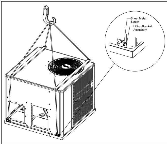
**Figure 1. Rigging Unit**
