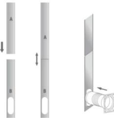
**ÉTAPE 4 :** Ouvrez la fenêtre et placez la trousse de fenêtre sur le bord intérieur de la fenêtre. Ajustez la plaque d'étanchéité de la fenêtre à la largeur de la fenêtre. Une fois qu'elle est bien fixée, fermez la fenêtre pour la verrouiller en place.
