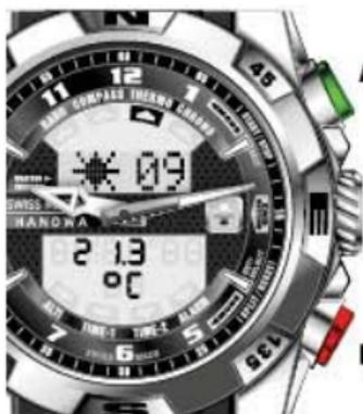
**A** → Si vous continuez à mesurer la température, les aiguilles sont placées 20 secondes sur 10h 10.
