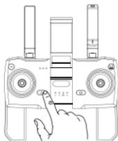
Appuyez sur le bouton Retour à la maison de votre émetteur ou sélectionnez cette fonction à partir de votre smartphone. L'émetteur commence à émettre des bips. L'appareil revient au point de décollage initial. Appuyez à nouveau sur le bouton pour arrêter la procédure RTH ou modifiez les joysticks gauche et droit pour forcer l'avion à atterrir ailleurs.
