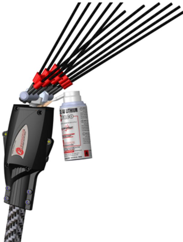
Posicionar la boquilla del aerosol hacia la rótula. Mantener el aerosol vertical y pulsar. Engrasar al mínimo una vez al día el cabezal de vibración (este engrase se efectúa sin desmontar nada).
