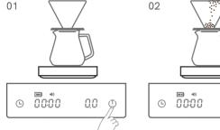
電源をいれた後、抽出器具をスケール上 に置き、ドリッパーにペーパーフィルタ ーをセットして、電源ボタンを短めにタ ッチして、重量が 0 セットします。(風 ペコェ)
