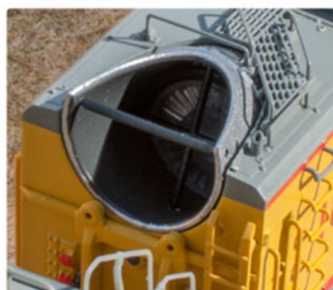
Turbine fan blade visible inside exhaust
