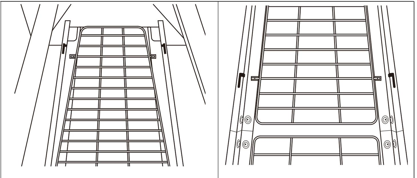
**FASE 9:** Fissare tutte le protezioni in rete superiori alla barra di supporto superiore (E) eccetto il lato anteriore.
