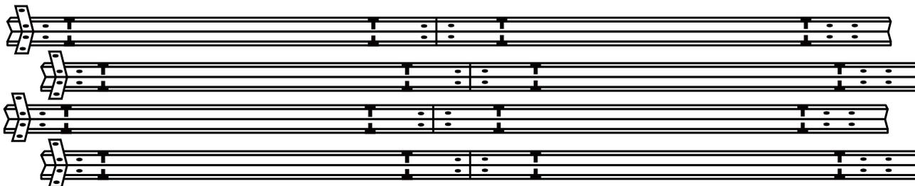
**FASE 3:** Svitare 2 viti M5 e rondelle (BB) preassemblate nella barra di supporto - inferiore (F).
