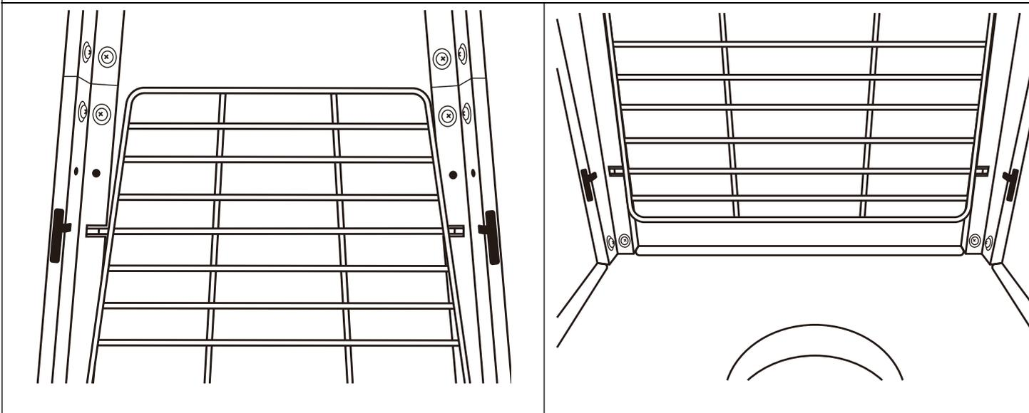
**FASE 7:** Inserire le 4 estremità sporgenti di ciascuna protezione a rete inferiore (D) nelle fessure del sedile della barra di supporto inferiore (F) come mostrato in figura. Fissare tutte le protezioni in rete inferiori (D) tranne il lato anteriore.
