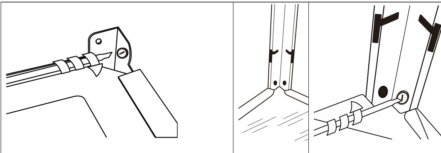
**FASE 6:** Svitare 8 viti M5 e rondelle (BB) preassemblate sulla parte superiore del gruppo alloggiamento del serbatoio (K). Posizionare le barre di supporto inferiori sulla parte superiore del gruppo dell'alloggiamento del serbatoio. Assicurarsi che le estremità superiori del gruppo dell'alloggiamento del serbatoio corrispondano alla fessura della barra di supporto inferiore. Abbinare il foro filettato e fissare ogni connessione con 2 viti M5 e rondelle (BB)
