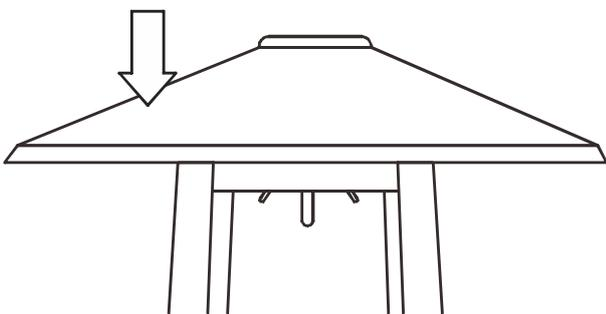
**FASE 5:** Posizionare il riflettore (A) sullo schermo antifiama (B) e fissare la connessione utilizzando 4 DADI M5 CAP (AA).
