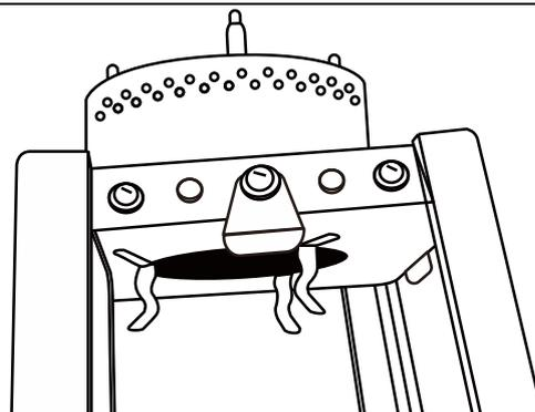
**FASE 4:** Attaccare lo schermo antifiama (B) alla parte superiore della barra di supporto superiore (E) e fissare la connessione utilizzando 2 viti M5 e rondelle (vedere la figura I , II).
