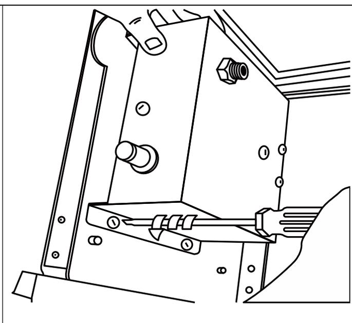
**PASSO 1:** Posizionare il gruppo dell'alloggiamento del serbatoio (K) come mostrato sopra. Abbassa la porta ed elimina tutte le parti.
