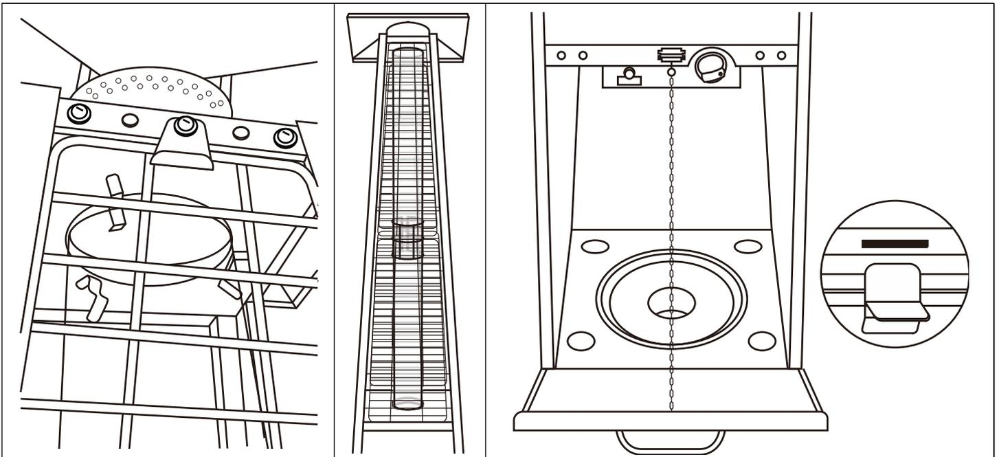
**FASE 11:** Montare la protezione della rete inferiore (D) e la protezione della rete superiore (C) nella parte anteriore. Fissare le piastre di fissaggio della protezione 4 pezzi per mantenere saldamente in posizione la protezione superiore della rete (C).
