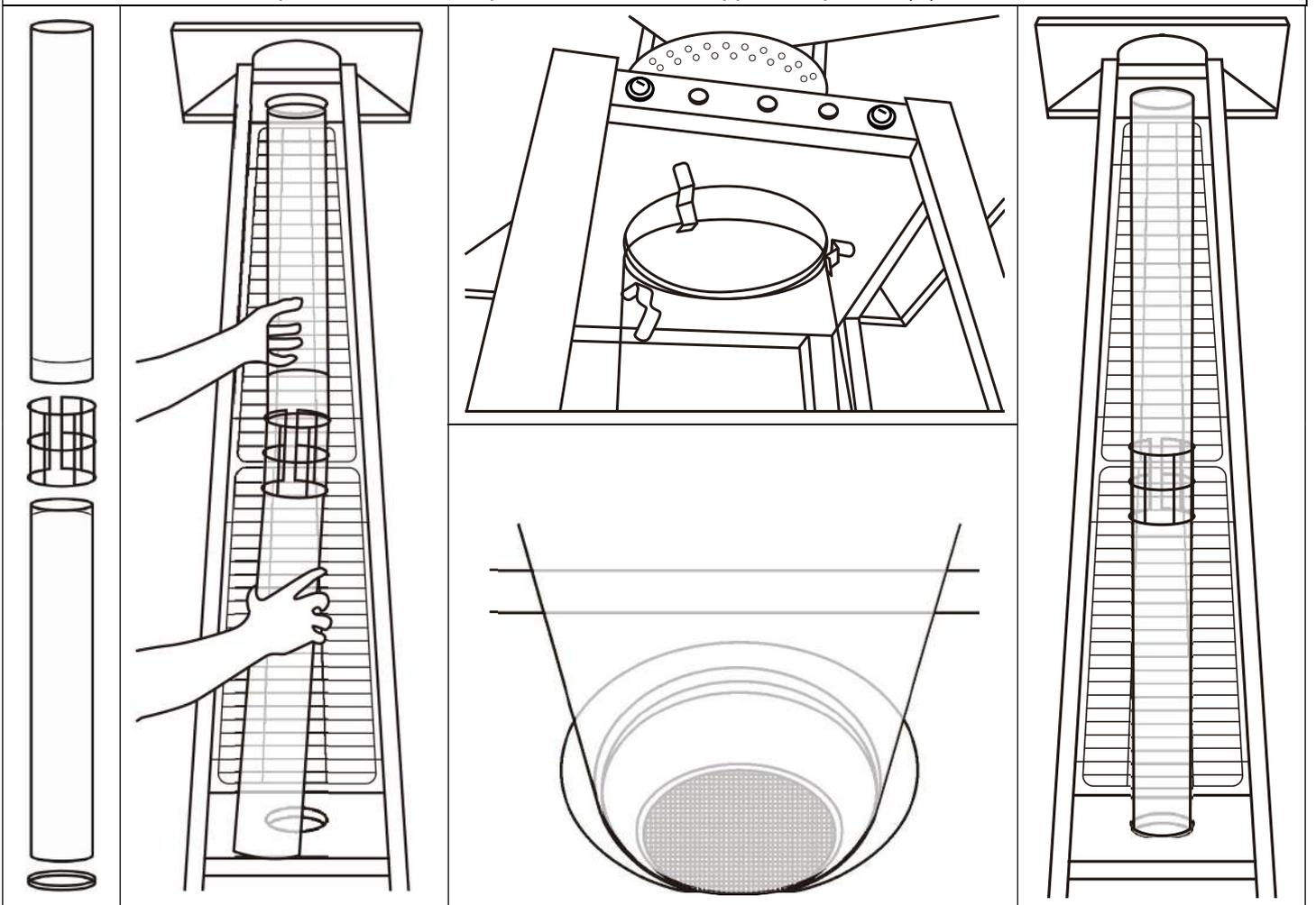
**FASE 10:** Mettere l'anello di gomma (I) attorno al foro del bruciatore. Collegare 2 tubi di vetro (G) con il connettore (H). Tenere con cura l'intero gruppo del tubo di vetro. Inserire l'estremità superiore nel foro inferiore dello schermo antifiama il più possibile. Tenere l'intero gruppo del tubo di vetro verticalmente e posizionarlo sull'anello di gomma (I).
