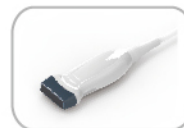
5.3MHz-11.0MHz Linear L7S-A
