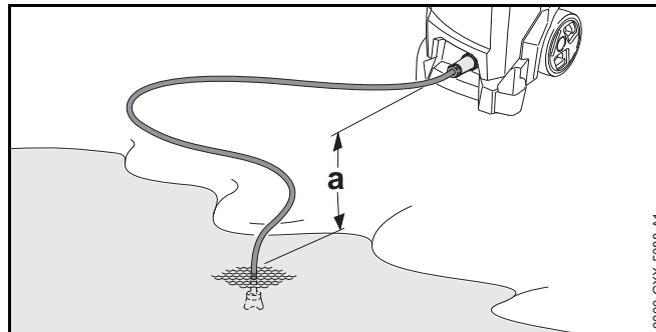
Pour que l'eau puisse être aspirée, la différence de hauteur entre le nettoyeur à pression et la source d'eau ne doit pas dépasser la hauteur d'aspiration maximale (a),
