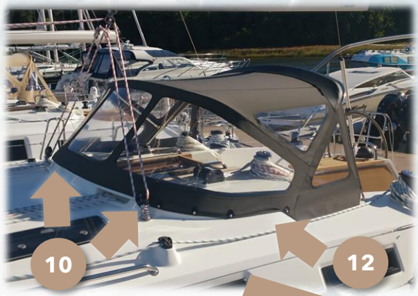
Sprayhood som monteras med en mittskena och plastknappar längs sidorna
