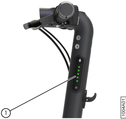
Fig. 17: Vérification de l'état de la batterie
