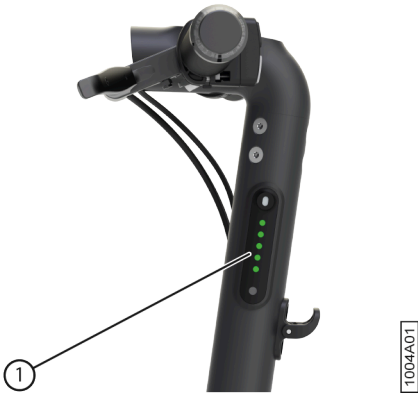
Fig. 17: Kontrolle des Batteriestatus
