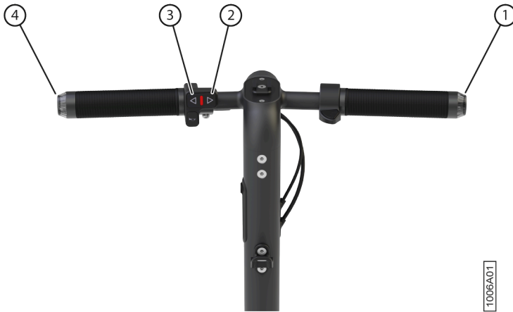
Fig. 13: Verwendung der Blinker
