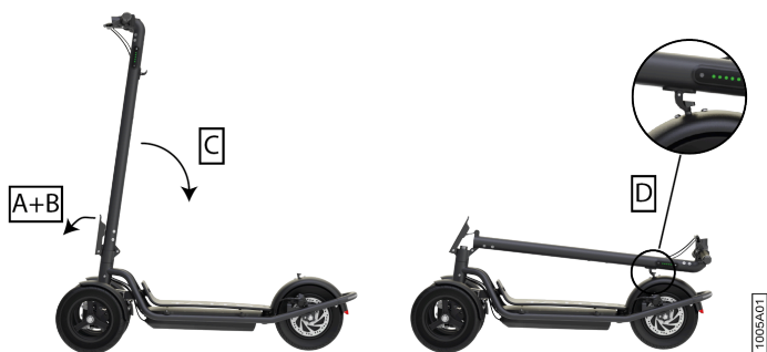
Fig. 6: Den Taito zusammenklappen
