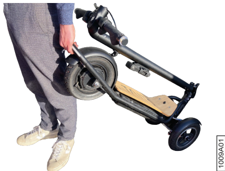
Fig. 8: Den Taito schieben (zusammengeklappt)
