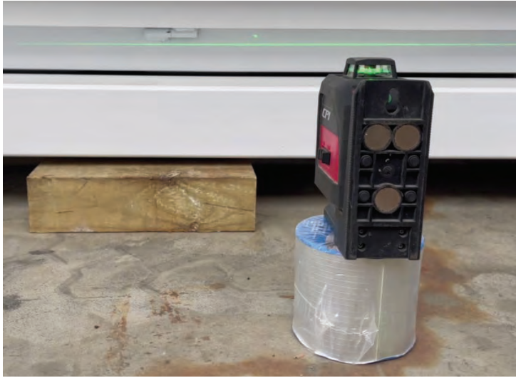
Plane laser level on long edge
