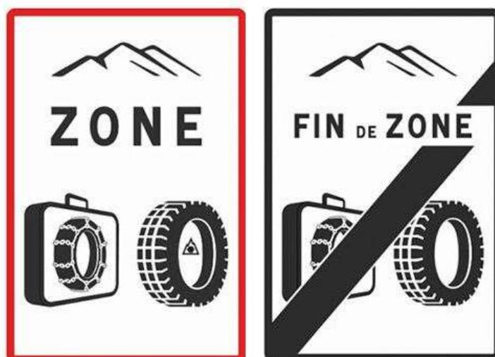
Les nouveaux panneaux de signalisation B58 et B59 signalant le début et la fin des sections d'équipement d'hiver
