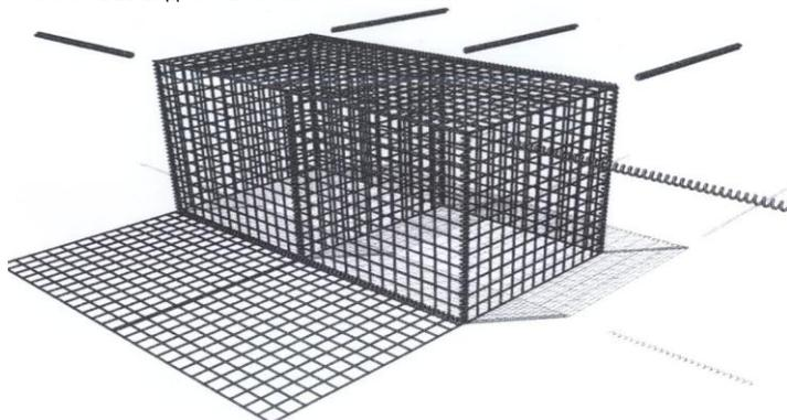
**Стъпка 5.** - Поставете разпънките от комплекта по следния начин: За габион с ширина **50cm** разпънките са успоредни на Ширината (W)-захващат двете срещуположни вертикални стени. За габион с ширина **100cm** разпънките са успоредни на диагонала-захващат две съседни вертикални стени. Разпънките се поставят равномерно, за да не се издуват стените на габиона след запълване му с камъни.
