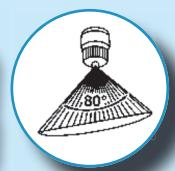
Всичките високопроизводителни пръскачки GLORIA са снабдени с **месингова дюза за плоска струя Тип 8004E**. Ъгълът на разпръскване е 80°. Подходящи са за обработване на повърхности.
