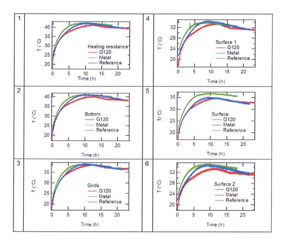
Des évolutions de température semblables ont été observées pour les 3 éprouvettes. Les légères différences d'évolution de température observées entre les 3 éprouvettes ne sont pas caractéristiques de la nature du renforcement mais des différences d'évolution du chauffage comme montré par les mesures du thermocouple 1C et qui peut être attribué aux conditionnements environnementaux différents durant les essais.
