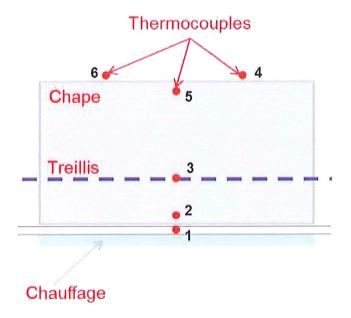
Les évolutions des températures en fonction du temps des différents thermocouples pour chaque éprouvette sous chauffage (appliqué au-dessous des éprouvettes) sont affichées ci-dessous.
