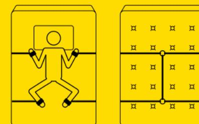
Una vez colocadas las cuerdas bajo la cama, ajustarlas según se necesite para conseguir la tensión deseada.
