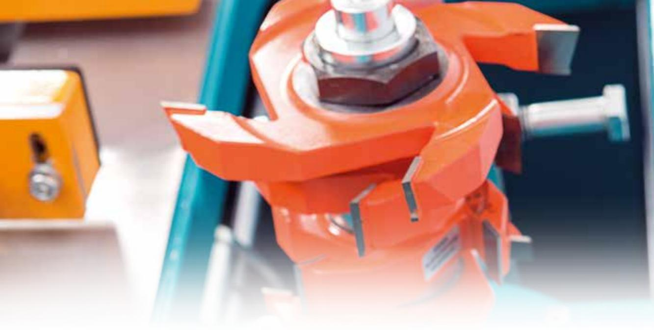
Alüminyum profilleri hassas bir biçimde alıştırma (kertme) işlemlerinde kullanılan manuel olarak çalışan kesme makinesidir.
