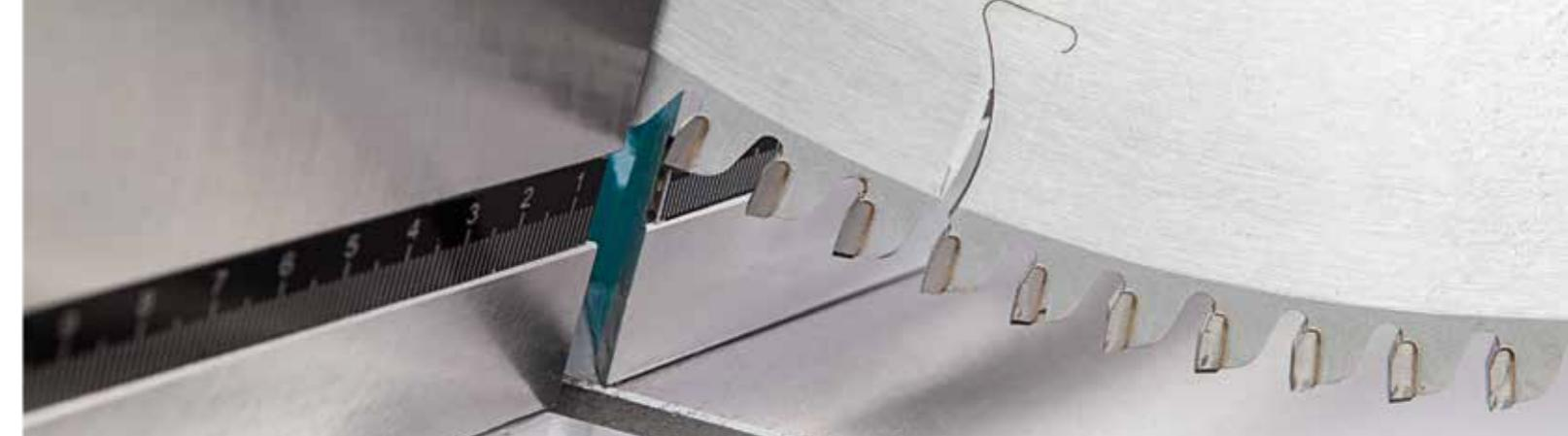
KD 402 S geniş ebatlı alüminyum profilleri, düz veya açılı olara, çift kafa Ø 400 mm testere ile kesmek amacıyla tasarlanmış kesme makinesidir.
