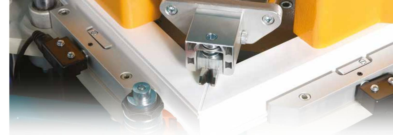
90° açı ile kaynatılmış PVC profillerin alt, üst ve dış köşe yüzeylerini temizler.
