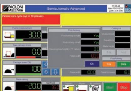
Der Programm ermöglicht die Digitalfunktion zur elektronischen Einstellung der waagrechten und senkrechten Ausrichtung des Vorritzblatts, Blattdurchmesser 230 mm, mit maximalem Überstand von 45 mm.
