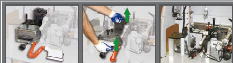
IT Sgancio rapido vasca colla - EN Quick release Glue pot - FR Bac à colle équipé du système de décrochage rapide DE Leimbecken mit schnellausspannung - ES Depósito de cola dotado de sistema de desenganche Rápido
