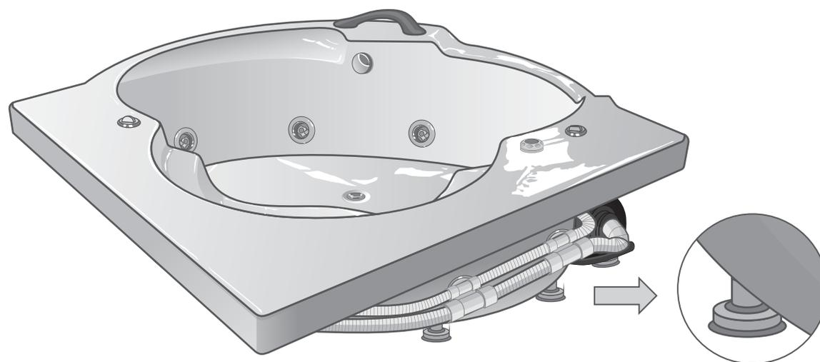
La cantidad de soportes dependen del diseño de la tina y la superficie en donde se va a instalar.
