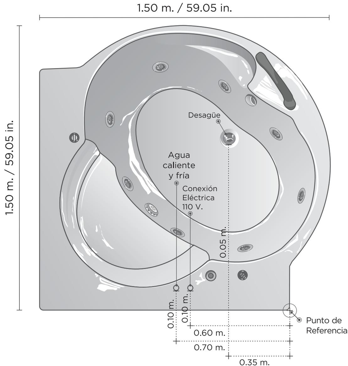
Será necesario proporcionar tres elementos importantes y al alcance del área del equipo para el funcionamiento de la tina.
