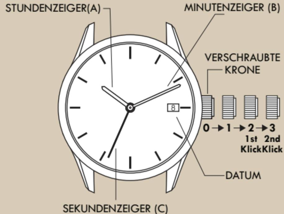
Wenn Ihre Uhr über eine verschraubte Krone verfügt, lösen Sie die verschraubte Position.
