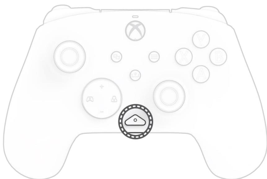
El controlador con cable REALMz cuenta con nuestro botón de "función" patentado en la parte inferior central del controlador (sobre el conector de audio). Este botón se puede utilizar para ajustar el volumen, silenciar el micrófono, cambiar los modos de iluminación LED y programar los botones traseros.
