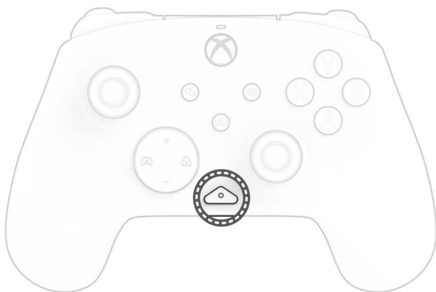
Il controller cablato REALMz è dotato del nostro pulsante brevettato "funzione" nella parte centrale inferiore del controller (sopra il jack audio). Questo pulsante può essere utilizzato per regolare il volume, disattivare il microfono, modificare le modalità di illuminazione a LED e programmare i pulsanti posteriori.
