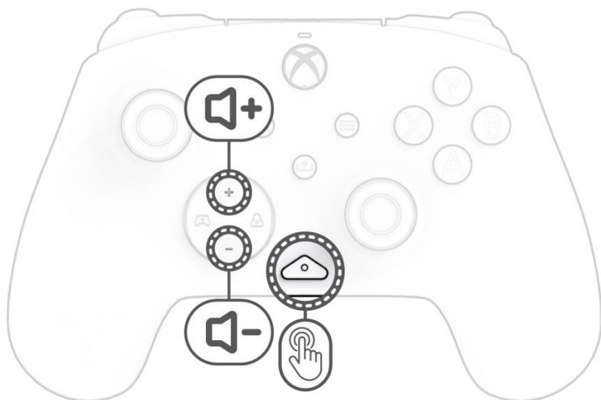
Przytrzymując przycisk „funkcja”, naciśnij przycisk D-Pada +W górę / -W dół, aby dostosować głośność gry.
