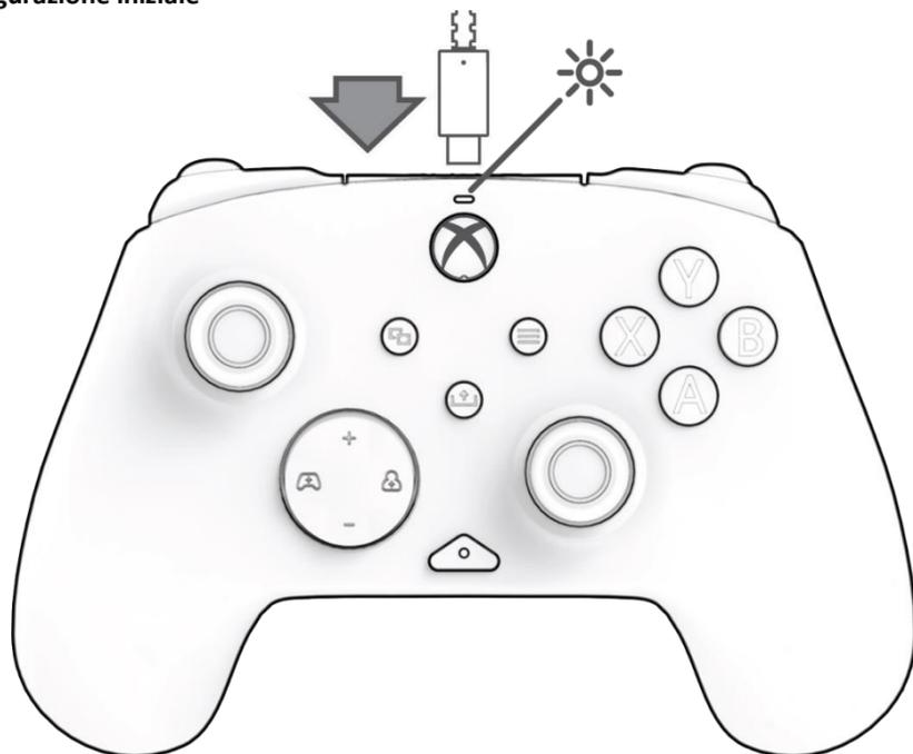
Inserire l'estremità USB-C del cavo nella parte superiore del controller e il lato USB nella console o nel PC. Comparirà la luce sopra il logo Xbox per indicare che è collegato.
