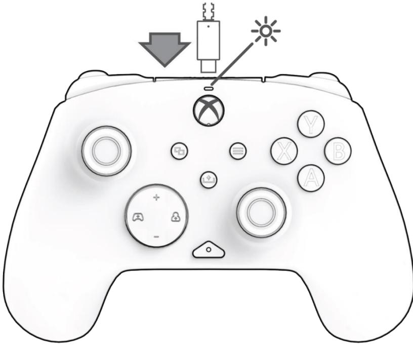
Sluit het USB-C-uiteinde van de kabel aan op de bovenkant van de controller en de USB-kant op je console of pc. Het lampje boven het Xbox-logo gaat branden om de verbinding aan te geven.
