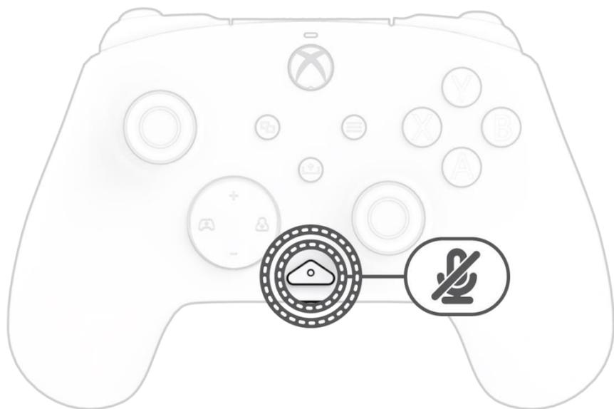
Para silenciar o microfone do fone de ouvido, pressione o botão “função” duas vezes. O LED do botão “função” acenderá para indicar que você está no modo silencioso. Para desativar o mudo, pressione o botão “função” duas vezes novamente.
