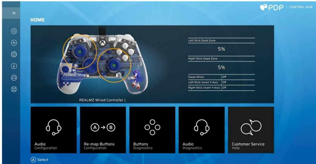
For at tilpasse din controller yderligere skal du downloade den gratis PDP Control Hub-app fra Windows Store på din PC eller Xbox. Brug den til at kortlægge knapper, køre diagnostik, recalibrere analoge pinde og udløser og meget mere.
