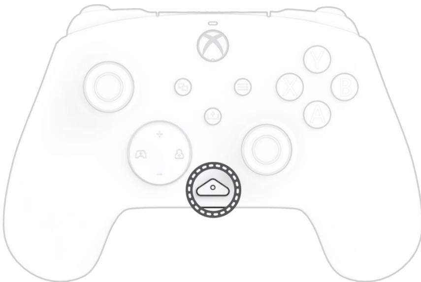
El control con cable REALMz cuenta con nuestro botón patentado “función” en la parte inferior central del control (sobre la toma de audio). Este botón se puede utilizar para ajustar el volumen, silenciar el micrófono, cambiar los modos de iluminación LED y programar los botones traseros.
