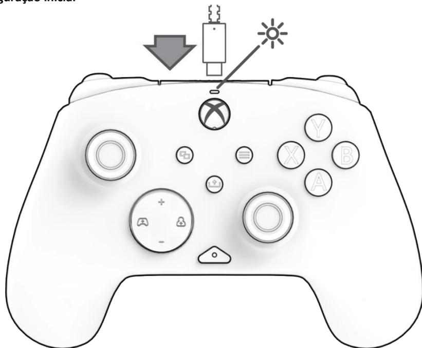
Ligue a extremidade USB-C do cabo à parte superior do controlador e o lado USB à sua consola ou PC. A luz por cima do logótipo da Xbox aparecerá para indicar que está ligado.
