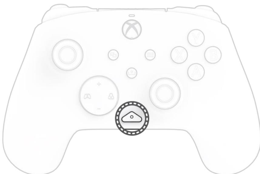
REALMz kablet controller har vår patenterte «funksjons»-knapp nederst på midten av kontrolleren (over lydkontakten). Denne knappen kan brukes til å justere volum, dempe mikrofonen, endre LED-belysningsmodus og programmere de bakre knappene.
