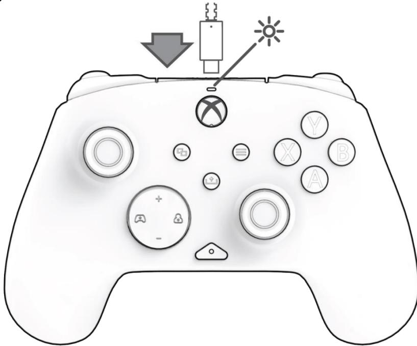
Conecta el lado USB-C del cable en la parte superior del control y el lado USB en tu consola o PC. La luz sobre el logotipo de Xbox aparecerá para indicar que está conectado.
