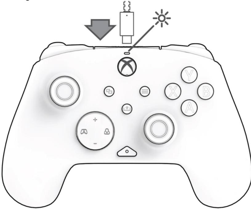
Schließe das USB-C-Ende des Kabels oben am Controller an und die USB-Seite an deiner Konsole oder deinem PC. Sobald das Licht über dem Xbox-Logo aufleuchtet, zeigt es an, dass die Verbindung hergestellt ist.
