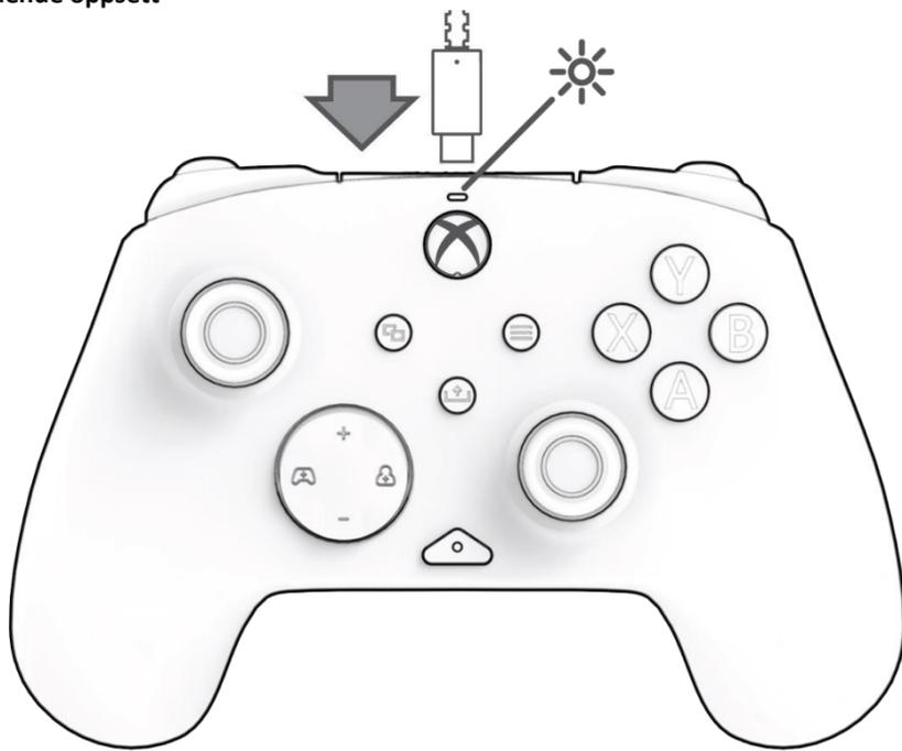
Koble USB-C-enden av kabelen til toppen av kontrolleren, og USB-siden til konsollen eller PC-en. Lyset over Xbox-logoen vises for å indikere at den er tilkoblet.
