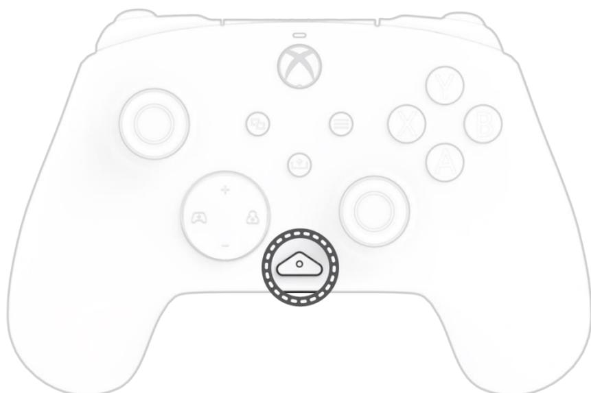
Kontroler przewodowy REALMz jest wyposażony w opatentowany przycisk „funkcja”, który znajduje się w dolnej części kontrolera (nad gniazdem audio). Ten przycisk służy do regulacji głośności, wyciszania mikrofonu, zmieniania trybów oświetlenia LED i programowania przycisków tylnych.
