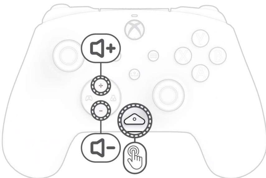
Mientras mantienes presionado el botón “función”, presiona los botones +Arriba/-Abajo del D-Pad para ajustar el volumen del juego.
