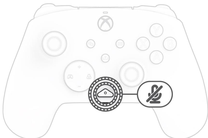
Per silenziare il microfono delle cuffie, premere due volte il pulsante “funzione”. Il LED sul pulsante “funzione” si accende per indicare che l’audio è stato disattivato. Per riattivare l’audio, premere di nuovo due volte il pulsante “funzione”.
