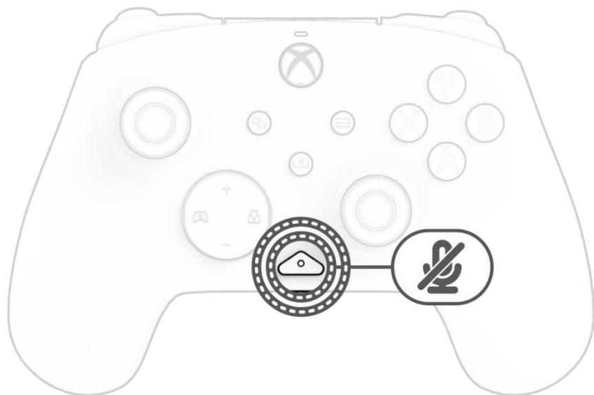
Trykk to ganger på «funksjon»-knappen for å dempe mikrofonen på hodesettet. LED-lampen på «funksjon»-knappen vil slå seg på for å indikere at du nå er dempet. Trykk to ganger på «funksjon»-knappen igjen for å oppheve dempingen.
