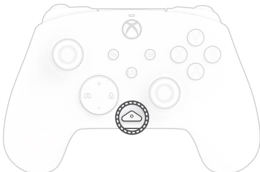
La manette filaire REALMz est dotée de notre bouton « fonction » breveté au centre inférieur de celle-ci (au-dessus de la prise audio). Ce bouton peut être utilisé pour régler le volume, mettre votre micro en sourdine, modifier les modes d'éclairage à DEL et programmer les boutons arrière.
