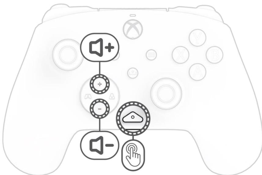
Mens du holder nede «funksjon»-knappen, trykk på D-Pad +Opp/-Ned for å justere spillvolumet.
