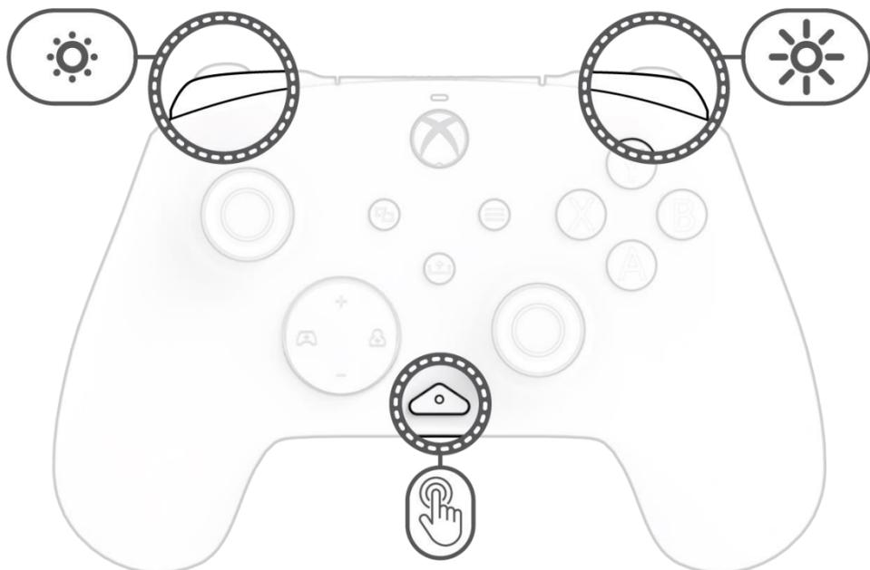
N. Ställ in LED-ljusstyrkan genom att hålla "Funktion"-knappen intryckt och trycka på LB-knappen för att öka och RB-knappen för att minska ljusstyrkan.
