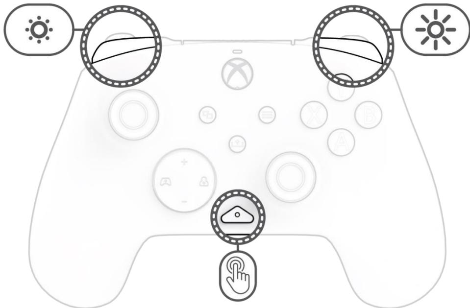
L. Para ajustar a intensidade do LED, mantenha pressionado o botão “função” e pressione LB para reduzir a intensidade, ou RB para aumentá-la.
