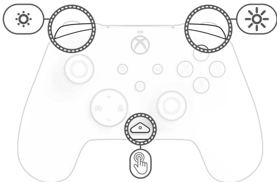
D. Para ajustar el brillo de la luz LED, mantén presionado el botón “función” y presiona LB para disminuir el brillo, o RB para aumentarlo.
