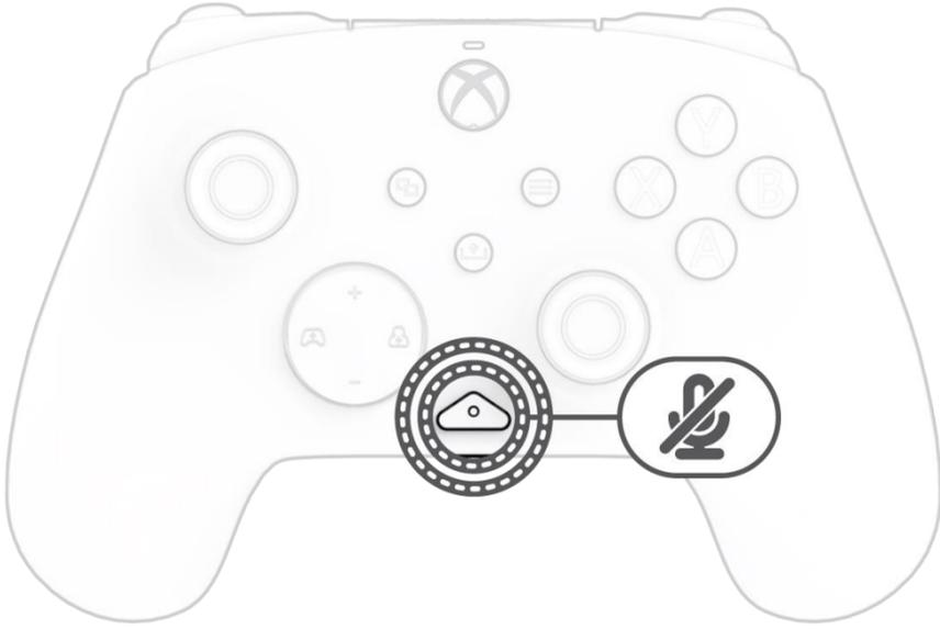
Para silenciar o microfone dos auscultadores, prima duas vezes o botão “função”. O LED no botão “função” acende-se para indicar que está silenciado. Para ativar o som, prima o botão “função” duas vezes novamente.
