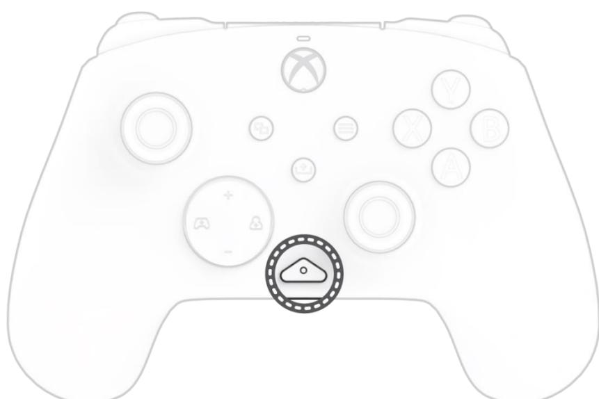
O controlador com fios REALMz tem o nosso botão patenteado de “função” na parte central inferior do controlador (acima da entrada de áudio). Este botão pode ser utilizado para ajustar o volume, silenciar o microfone, alterar os modos de iluminação LED e programar os botões traseiros.
