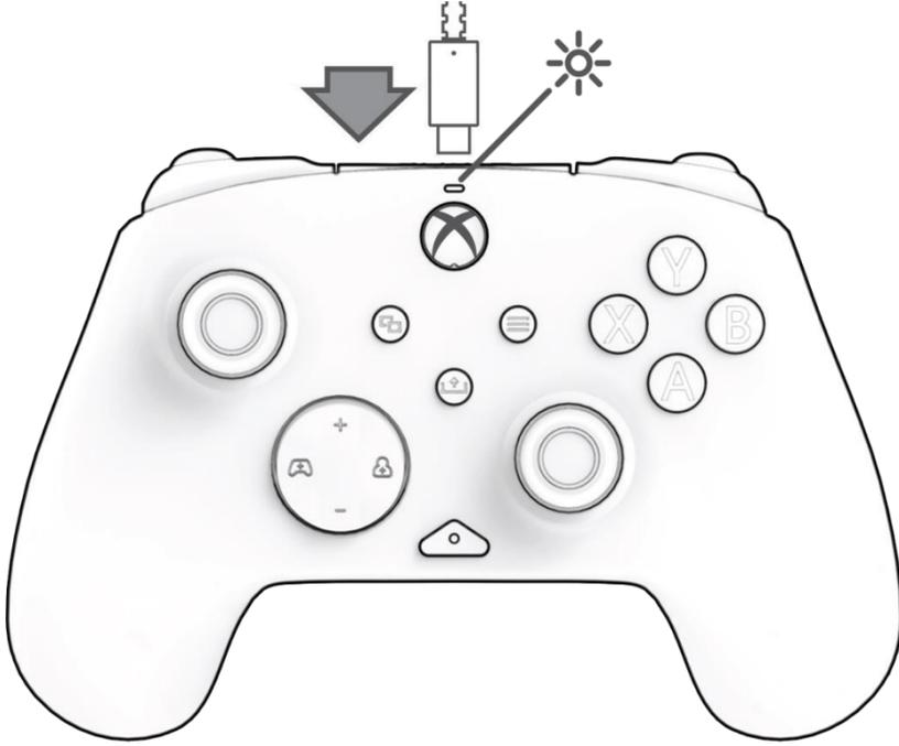
Sæt USB-C-enden af kablet i toppen af controlleren og USB-siden i din konsol eller PC. Lyset over Xbox-logoet vises for at angive, at det er tilsluttet.
