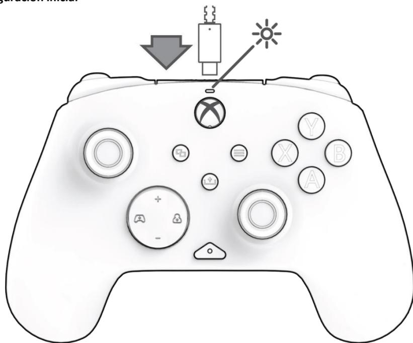
Conecta el extremo USB-C del cable en la parte superior del controlador y el lado USB en la consola o PC. Aparecerá la luz sobre del logotipo de Xbox para indicar que está conectado.
