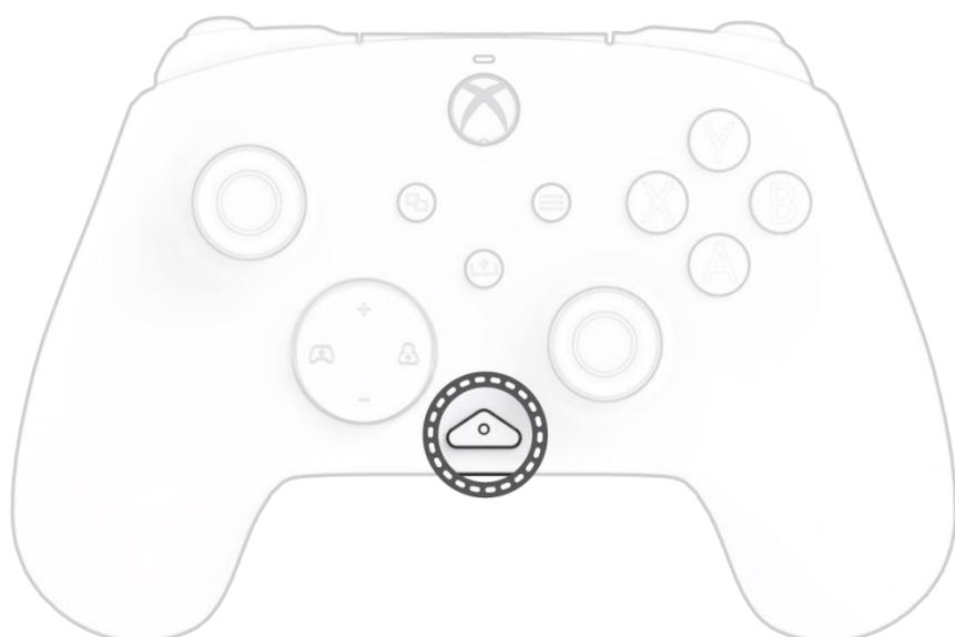
La manette filaire REALMz est dotée de notre bouton « Fonction » breveté en bas au centre de la manette (au-dessus de la prise audio). Ce bouton peut être utilisé pour régler le volume, couper le son de votre micro, modifier les modes d'éclairage LED et programmer les boutons arrière.
