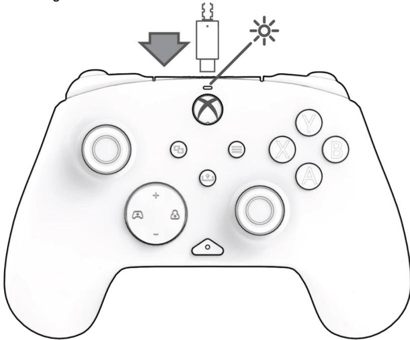
Anslut kabelns USB-C-ände på styrenhetens ovansida och den andra änden till konsolen eller datorn. Lampan ovanför Xbox-logotypen visar om styrenheten är ansluten.
