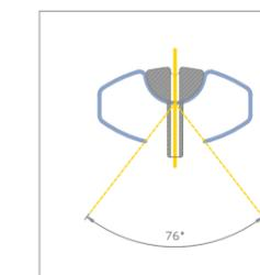
POWER HOLE よりも支点がフレーム内側にあるため、打球時のSTRING稼働域は76度。
