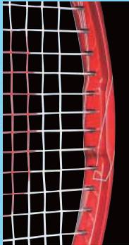
インサイドのグロメット部分を長方形のホールにすることで、ボールの反発力に影響をおよぼすメイン(縦)とクロス(横)ガットの長さを長くすることが可能になった。このことにより、従来インパクト時にストリングのたわむ範囲が内側のグロメット内だったものを、フレームの外側のグロメットにまで広げることで、フェイス・サイズを変えることなく従来のコントロール性を維持しながら、パワーを増大させる画期的な新機能。
