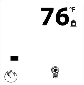
Pour verrouiller sur l'une des couleurs de roulement. Appuyez sur le bouton de réglage de la lumière fonction vers le bas "**▼**" à la sélection des couleurs. Puis instantanément appuyez sur le bouton jusqu'à "**▲**".
