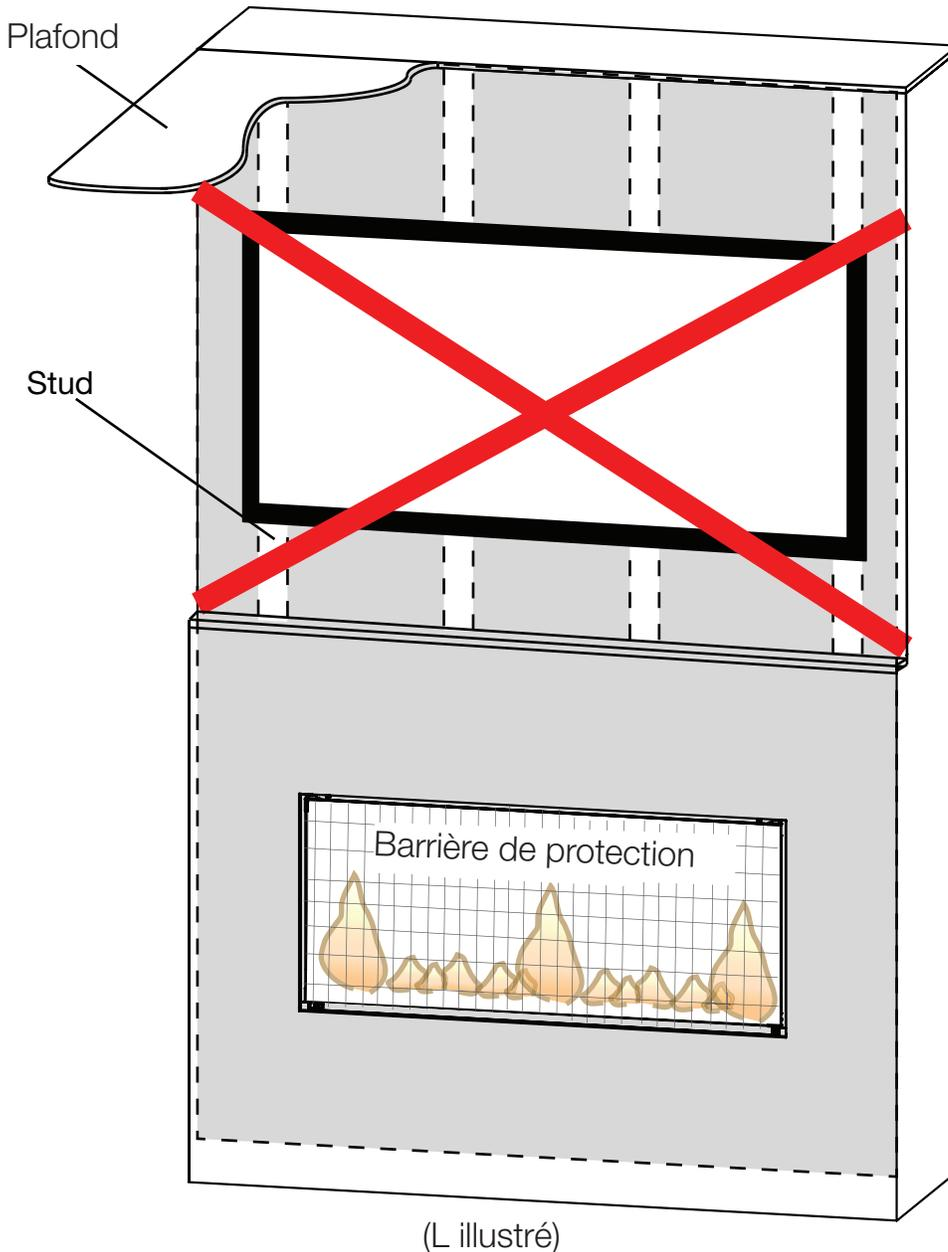
Les températures au-dessus de la cheminée pour les modèles L sera chauds, rendant impropres pour le montage d'un téléviseur ou autres objets sensibles à la chaleur au-dessus de la cheminée sans risques de dommages.
