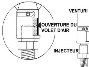
Plus le volet est fermé, plus la flamme est jaune et aura tendance à causer des dépôts de carbone. Plus le volet est ouvert, plus la flamme est bleue et plus elle a tendance à se détacher des orifices du brûleur. La flamme peut ne pas être jaune immédiatement; allouez de 15 à 30 minutes pour que la couleur finale de la flamme se stabilise.
