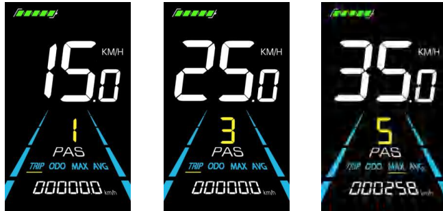
Figure 5-3 PAS level display interface
