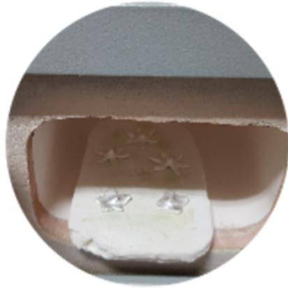
Tras un período de secado de 24 horas, se realiza la fase de cocción de la hoja en el horno eléctrico. Durante esta fase del proceso se destruye el material orgánico y se obtiene la hoja en Plata Pura (999).
