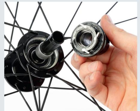
Leezes Freilauf lässt sich einfach abziehen und tauschen, die Keramiklager laufen seidenweich.
