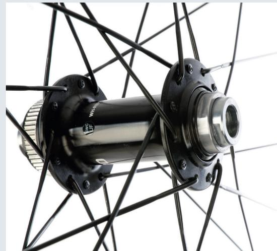
Neben all den Industrielagern im Test muten Shimanos Konuslager mit Schleifdichtung fast schon exotisch an.
