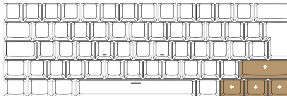
Quando la funzione TAP è abilitata, si accederà ai tasti freccia premendo breve (<200ms) i tasti FN1, FN2, Shift destro o Control destro. Tuttavia, la funzione predefinita verrà mantenuta per una pressione prolungata (>200ms), il che fornisce maggiore flessibilità e aumenta la funzionalità della tastiera.
