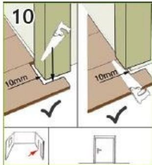
Türzargen aus Holz können gekürzt werden. Legen Sie dazu ein Paneel mit der Dekorseite nach unten gegen die Zarge. Kürzen Sie nun mit einer geeigneten Säge entlang des Paneels die Türzarge. Danach lässt sich das Laminat einfach mit der Dekorseite nach oben unter die Zarge schieben. Bei Türzargen, die nicht gekürzt werden können, schneiden Sie das Paneel entsprechend zu.
