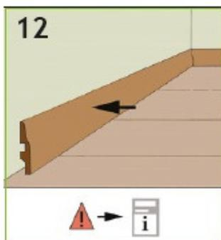
Sockelleisten werden nur an der Wand befestigt, nicht am Boden.
