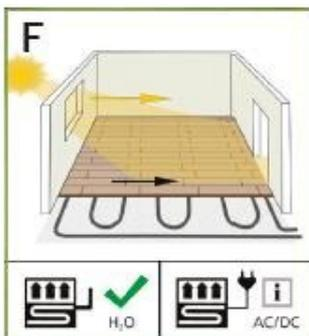
Aus optischen Gründen sollte Laminat immer in Längsrichtung zur Hauptlichtquelle verlegt werden. Berechnen Sie vor dem Verlegen wie breit die letzte Paneelreihe wird. Sie sollte nicht schmaler als 5 cm sein. Eventuell muss die erste Reihe bereits der Länge nach entsprechend zugeschnitten werden.
