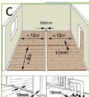
In Räumen, die in der Längsrichtung mehr als 12 m Länge und/oder in der Querrichtung mehr als 8 m Breite messen, muss zusätzlich ein Dehnungsprofil eingesetzt werden. Dies gilt auch für Türöffnungen, Raumdurchgänge, Mauervorsprünge und verwinkelte Räume.
