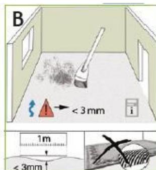
Der Untergrund muss rissfrei, sauber, zug-/druckfest und dauerhaft trocken sein (VOB, Teil C, DIN 18365). Entfernen Sie vor der Verlegung Altbeläge restlos vom Untergrund, soweit diese die Ebenheit des Untergrundes beeinflussen. Die Ebenheit des Untergrundes sollte auf 1 m nicht mehr als +/- 3 mm abweichen (DIN 18202). Lassen Sie ggf. den Verlegeuntergrund durch einen Bodenleger überprüfen.
