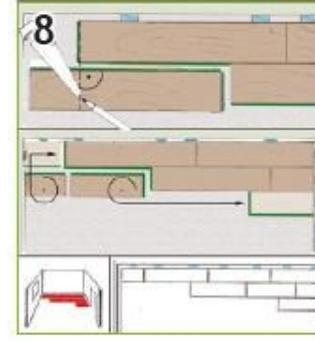
Der Versatz der Fugen zwischen den Reihen muss auch mindestens 40 cm betragen, damit die Nut- und Federverbindung stabil bleibt. Setzen Sie das zu verlegende Paneel in einem spitzen Winkel einfach an das schon liegende Paneel an und drücken es nach unten bis es hörbar einrastet. Der Winkel stimmt, wenn sich die Paneele einfach ohne Kraftaufwand verbinden lassen.
