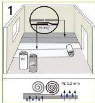
Bei Estrich- und Betonböden verlegen Sie zuerst parallel zum Laminat eine Dampfsperre. Entweder Sie lassen die Folienbahnen 20 cm überlappen oder Sie verkleben Stoß an Stoß. Auf jeden Fall sollte sie rund 3 cm Überstand an den Wänden aufweisen.
