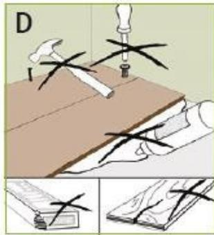
Der Boden wird schwimmend verlegt. Das heißt, dass der Boden nicht auf den Unterboden geklebt, genagelt oder auf andere Weise fixiert werden darf. Da Holz ein natürlicher Stoff ist, arbeitet der Bodenbelag. Durch die schwimmende Verlegung und den Wandabstand geben Sie der verlegten Fläche den möglichen Spielraum für minimale Bewegungen.
